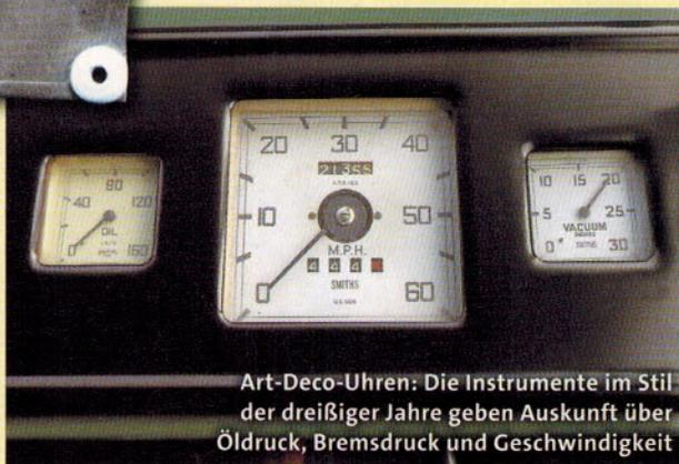
Art-Deco-Uhren: Die Instrumente im Stil der dreißiger Jahre geben Auskunft über Öldruck, Bremsdruck und Geschwindigkeit
