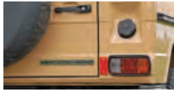
Der Vierzylinder-Diesel läuft relativ leise. Kennzeichen der W 460-Baureihe: Tanköffnung am Heck. Doppel-Zughebel für die Achssperren. Überraschend wohlliches Interieur
