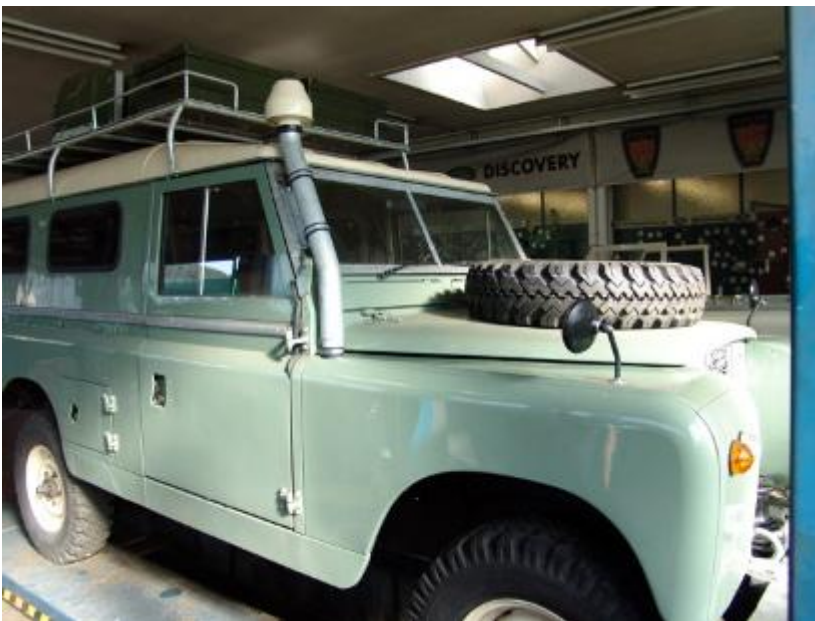
Für Wasserdurchfahrten haben wir diesen Schnorchel in Fahrzeugfarbkombination angefertigt.
