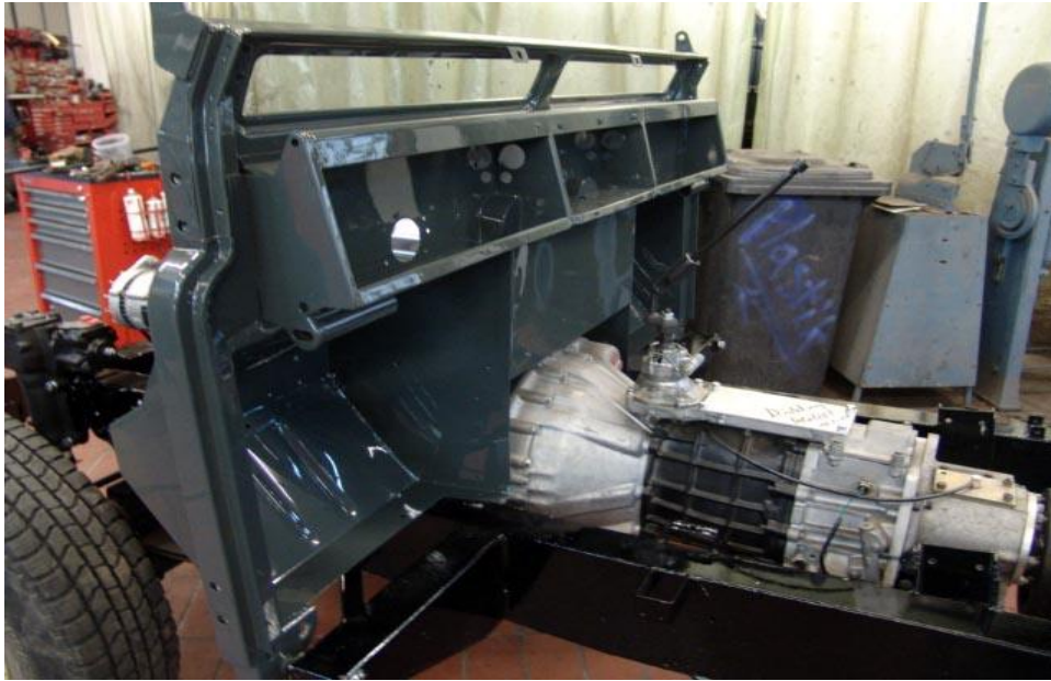
Rolling Chassis mit neuer Spritzwand
