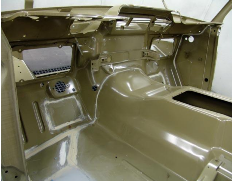
SÄMTLICHE Karosserienähte werden sauber abgedichtet, bevor die Karosserie in schwarz Seidenmatt lackiert wird.
