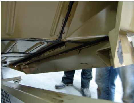
SÄMTLICHE Karosserienähte werden sauber abgedichtet, bevor die Karosserie in schwarz Seidenmatt lackiert wird.
