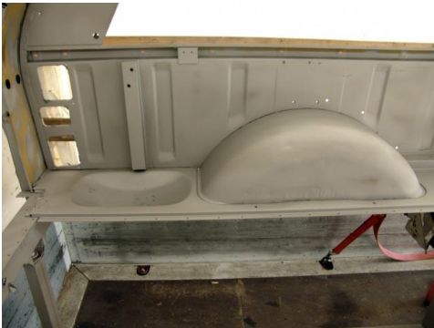
Nach dem Sandstrahlen sieht man schon deutlich größere Schäden.
