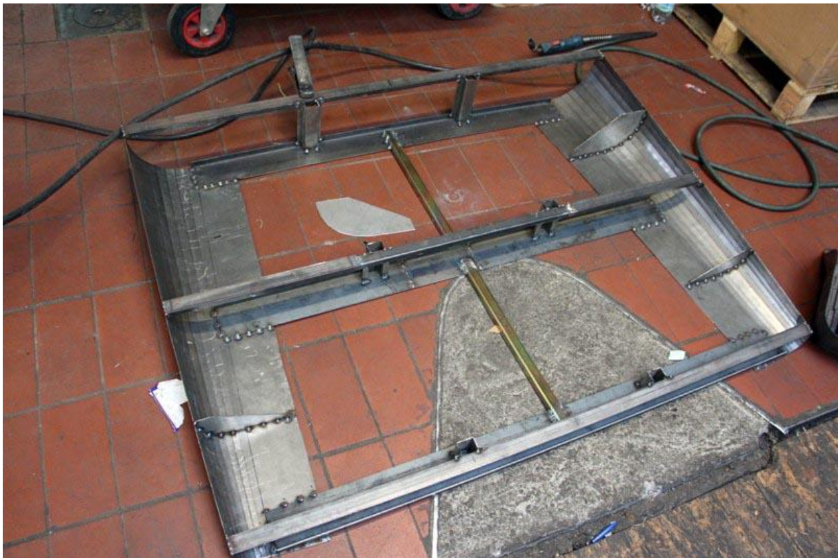
für die Innendachschale wird eigens eine Form angefertigt...
