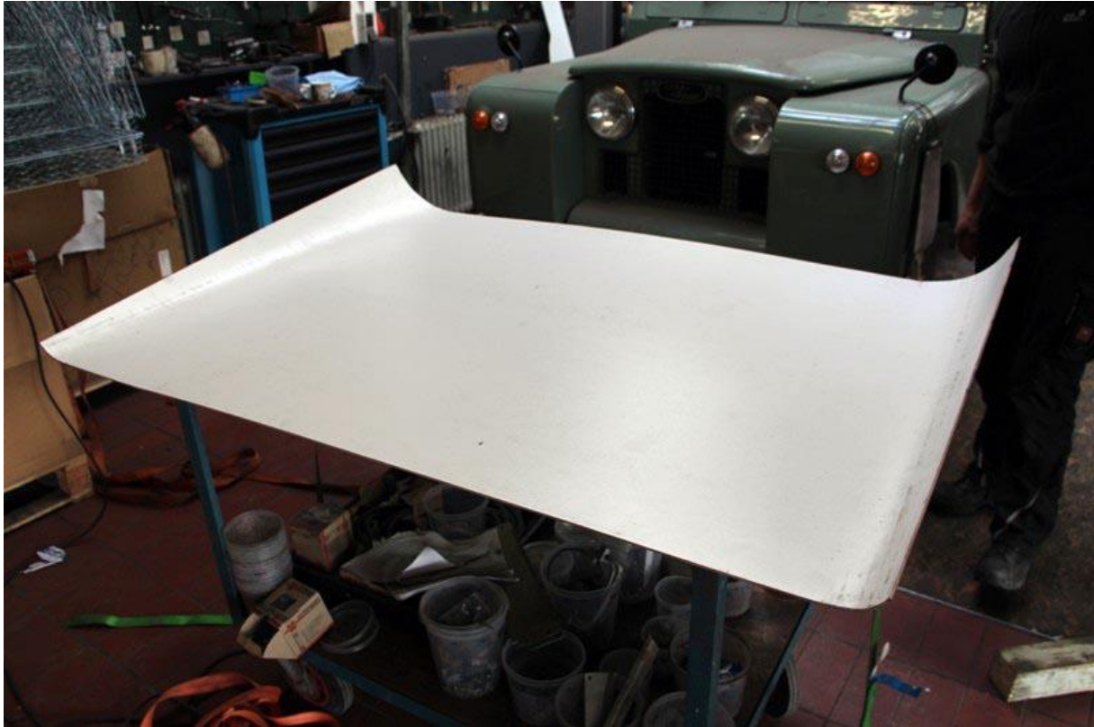
...und so eine passgenaue Dachschale gefertigt.
