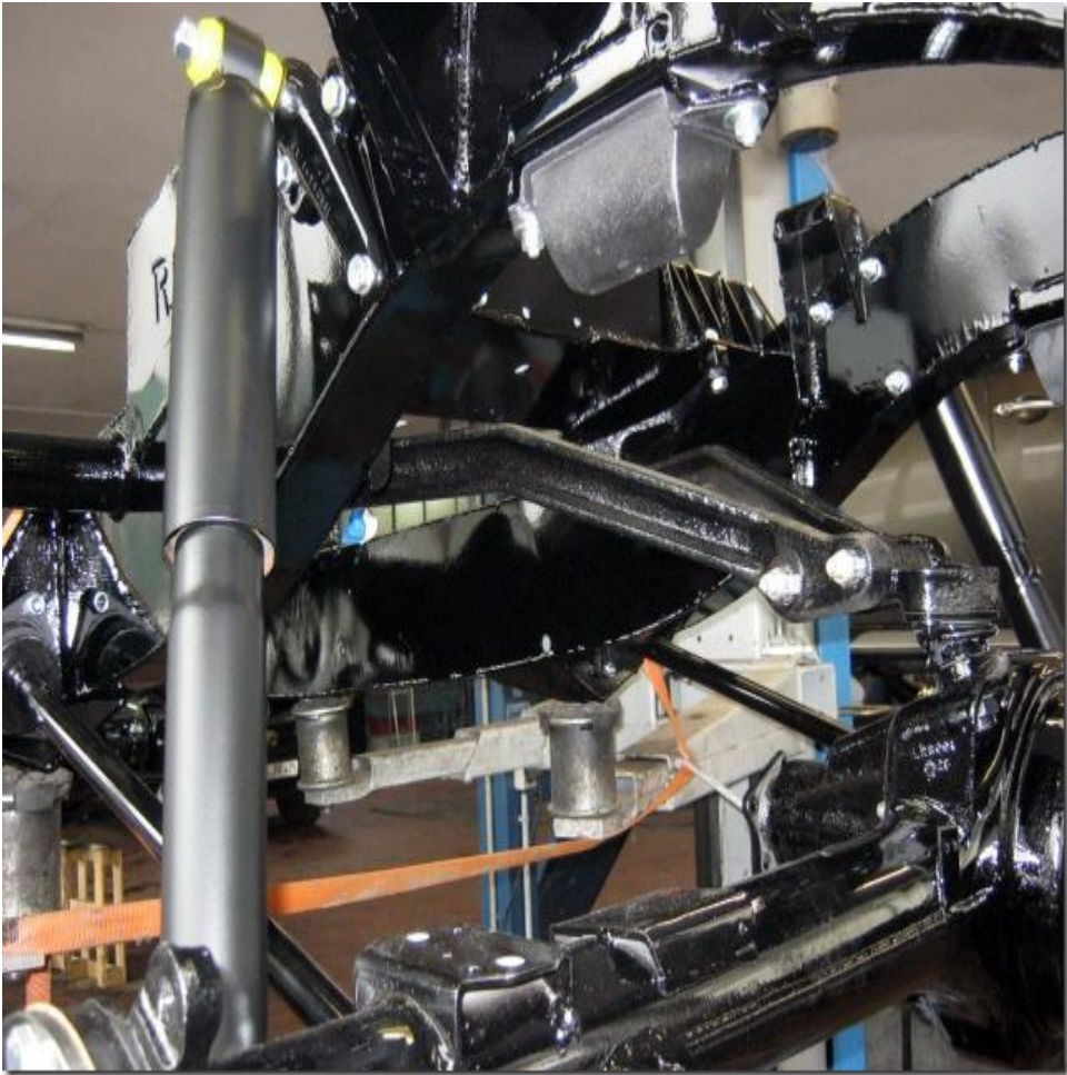
Die Vorderachse mit montierten Zugstreben.
