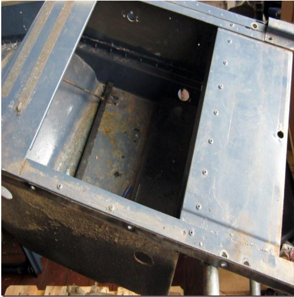
Der Sitzkasten ist ein weiterer Hort für Rost, gerade bei neueren Defender bei denen
