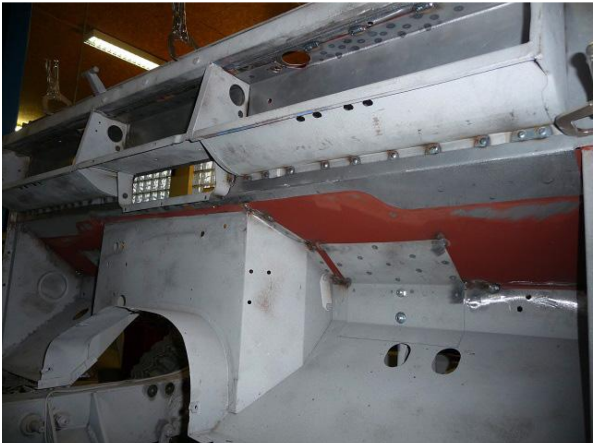
Die Spritzwand von der Vorderseite mit den bereits neu eingeschweißten Blechen.
