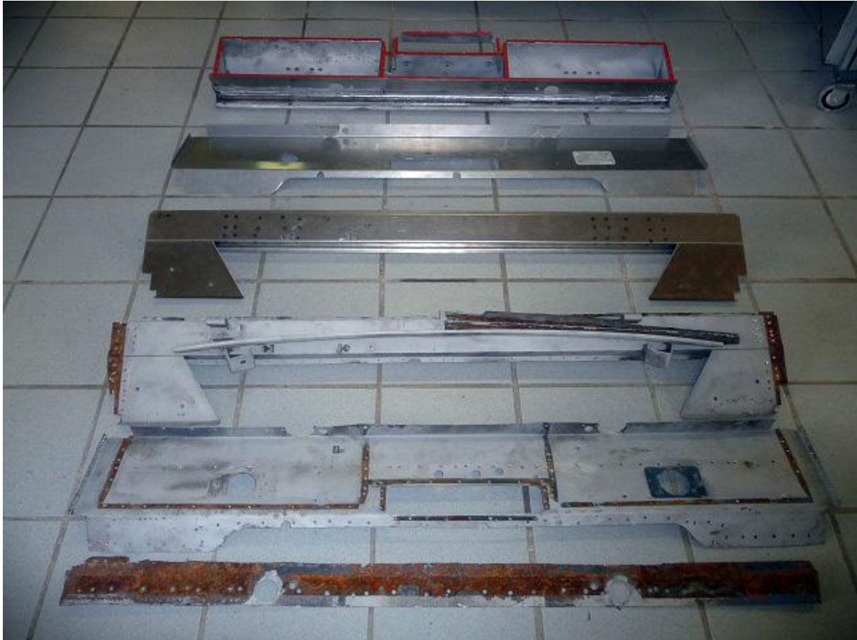
Hier alle alten und neuen Teile der Spritzwand, es wird deutlich welcher Aufwand hier getrieben wird.
