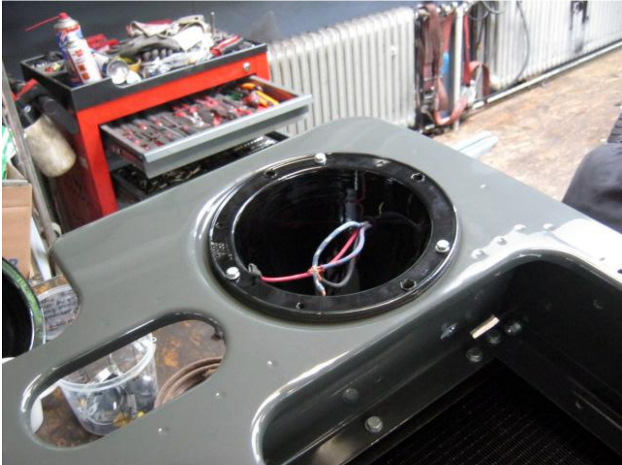
Nachdem alle Teile lackiert sind, wird der Landy endgültig zusammengebaut, hier die Frontmaske mit neuen Lampentöpfen.
