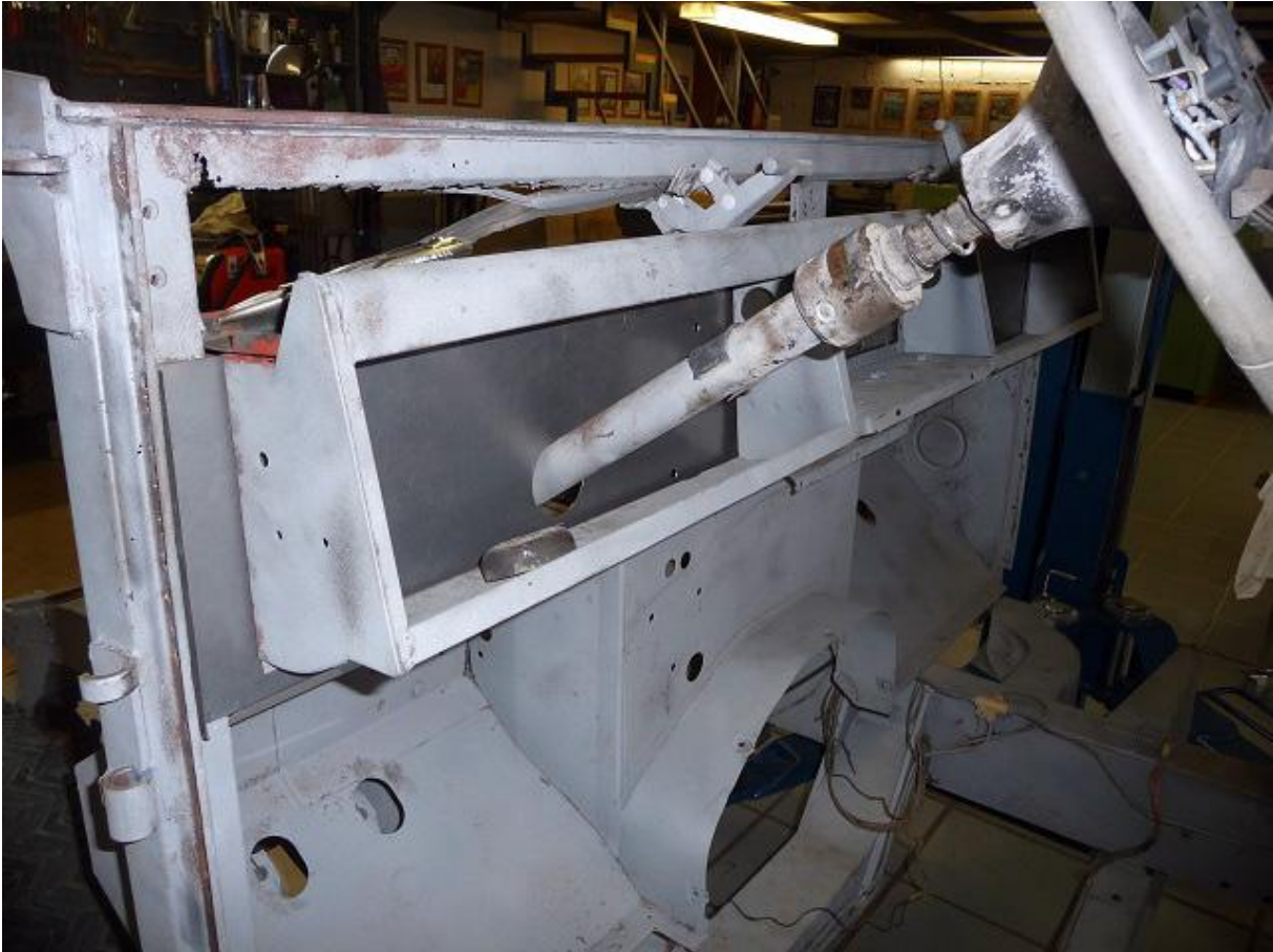
Die Spritzwand ist wohl eine von den aufwendigsten Baustellen dieser Serie I.
