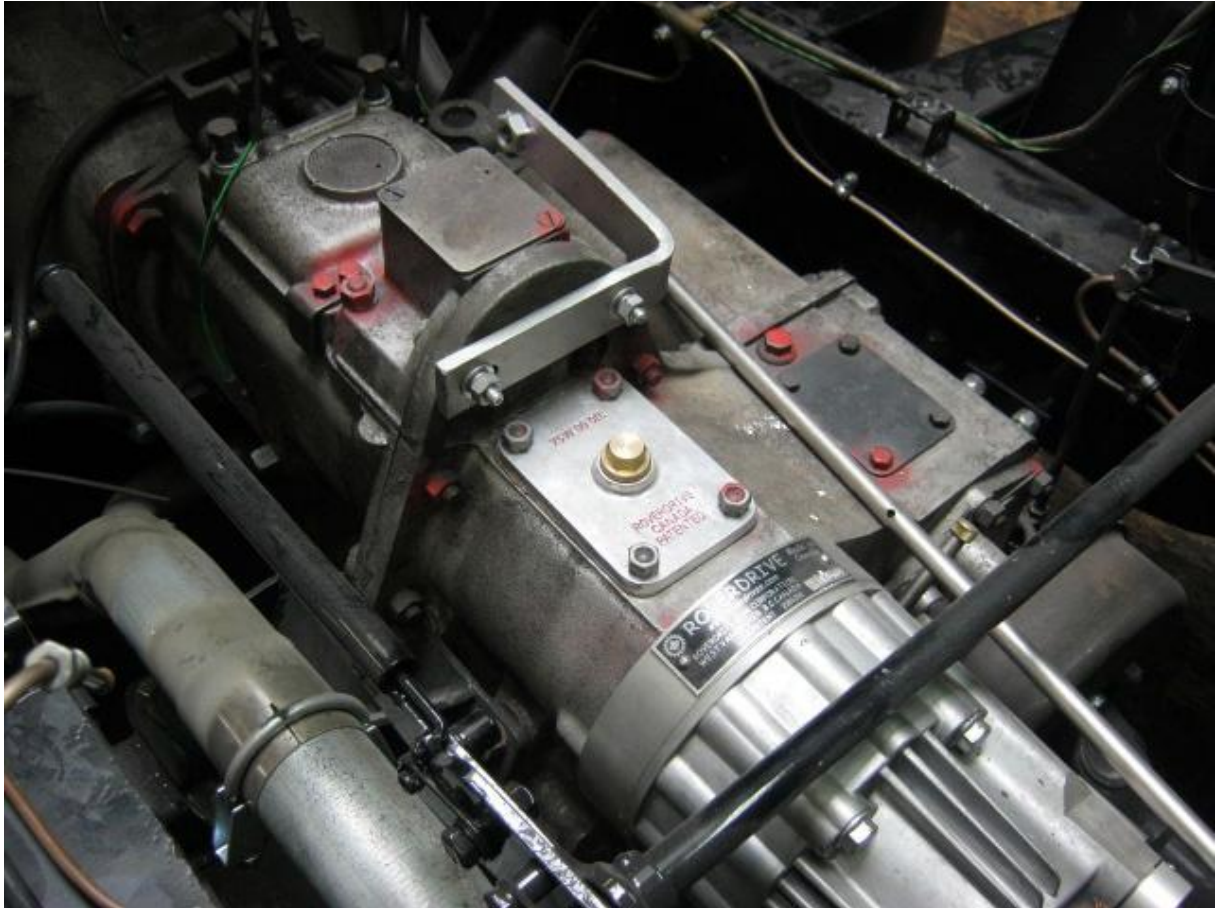
Das Getriebe ist frisch überholt, der neue Overdrive ist angeflanscht.
