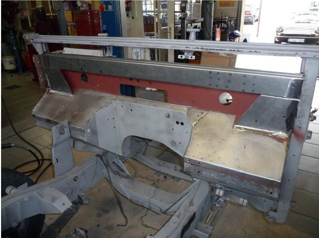
Die Spritzwand von der Vorderseite mit den bereits neu eingeschweißten Blechen.
