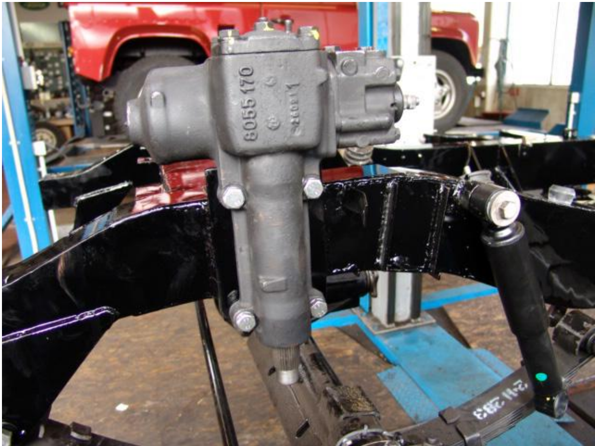
Am Rahmen wird eine Adapterplatte appliziert, um die Servolenkung aufzunehmen.
