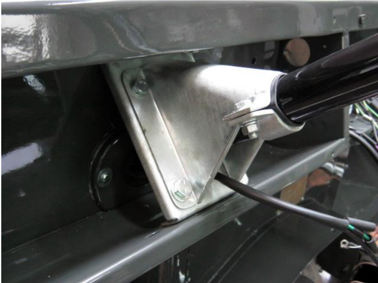
Sämtliche Metallteile wurden gesandstrahlt und frisch verzinkt.
