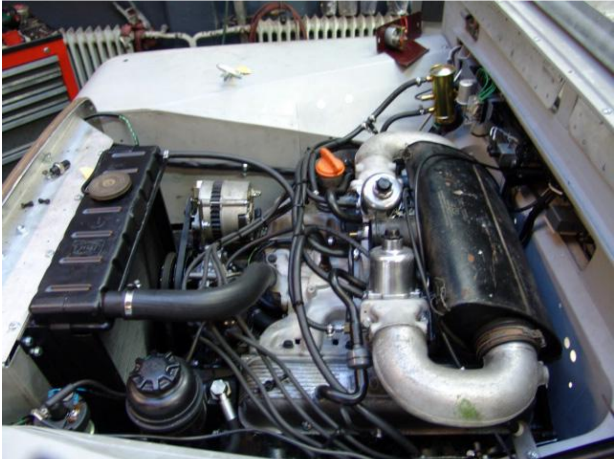
Der V8 Motor wird neu verkabelt und angeschlossen.
