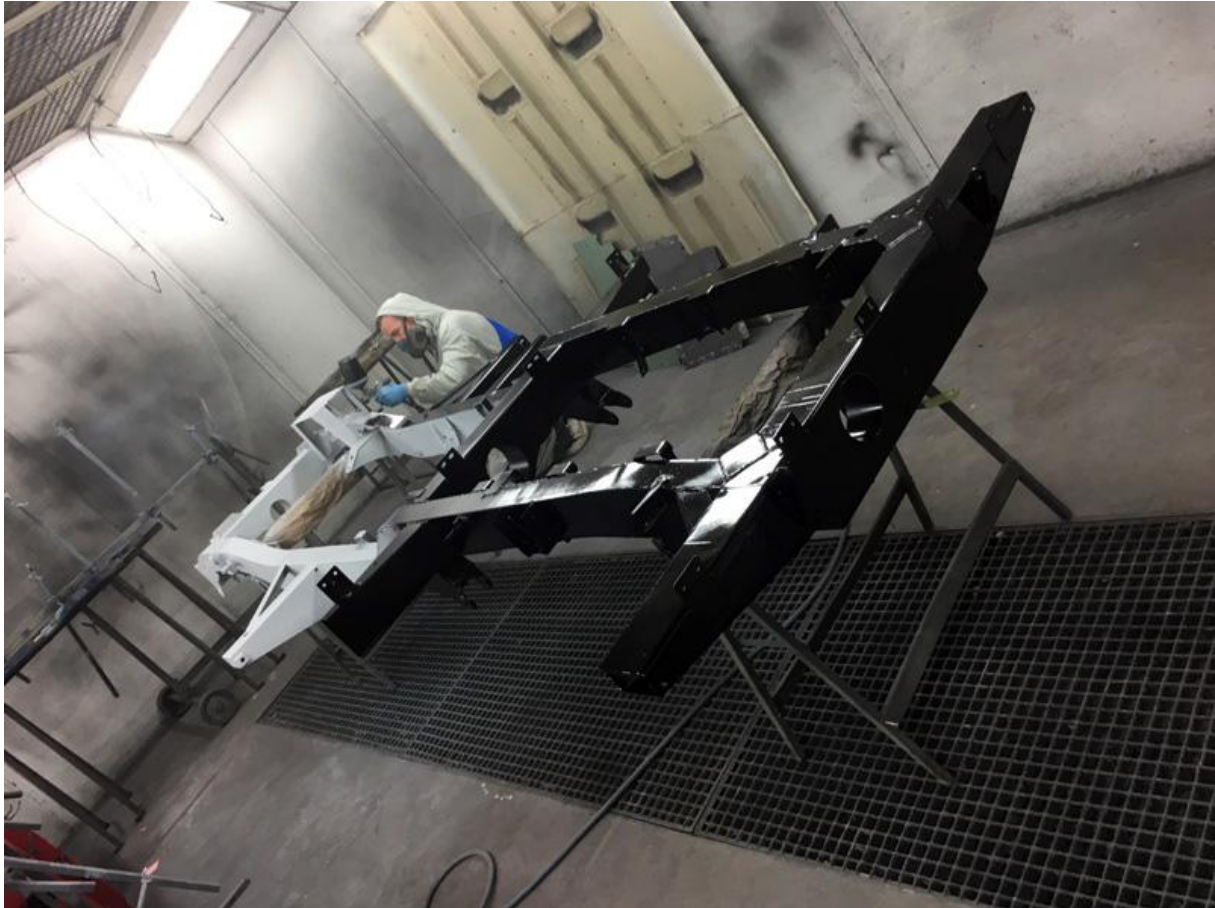
Das neue verzinkte Chassis wird schwarz lackiert.
