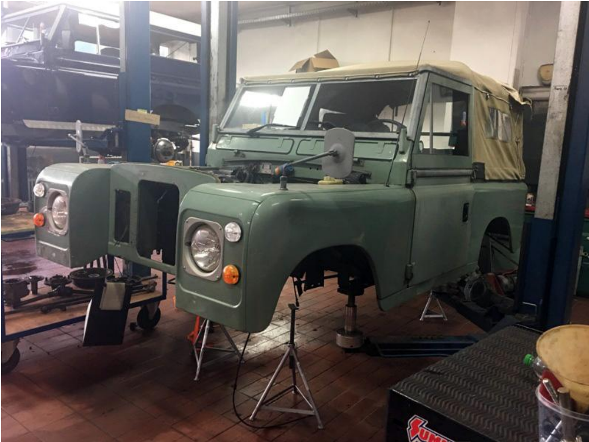
Die Karosserie wird mit unseren Spezialträgern abgehoben
