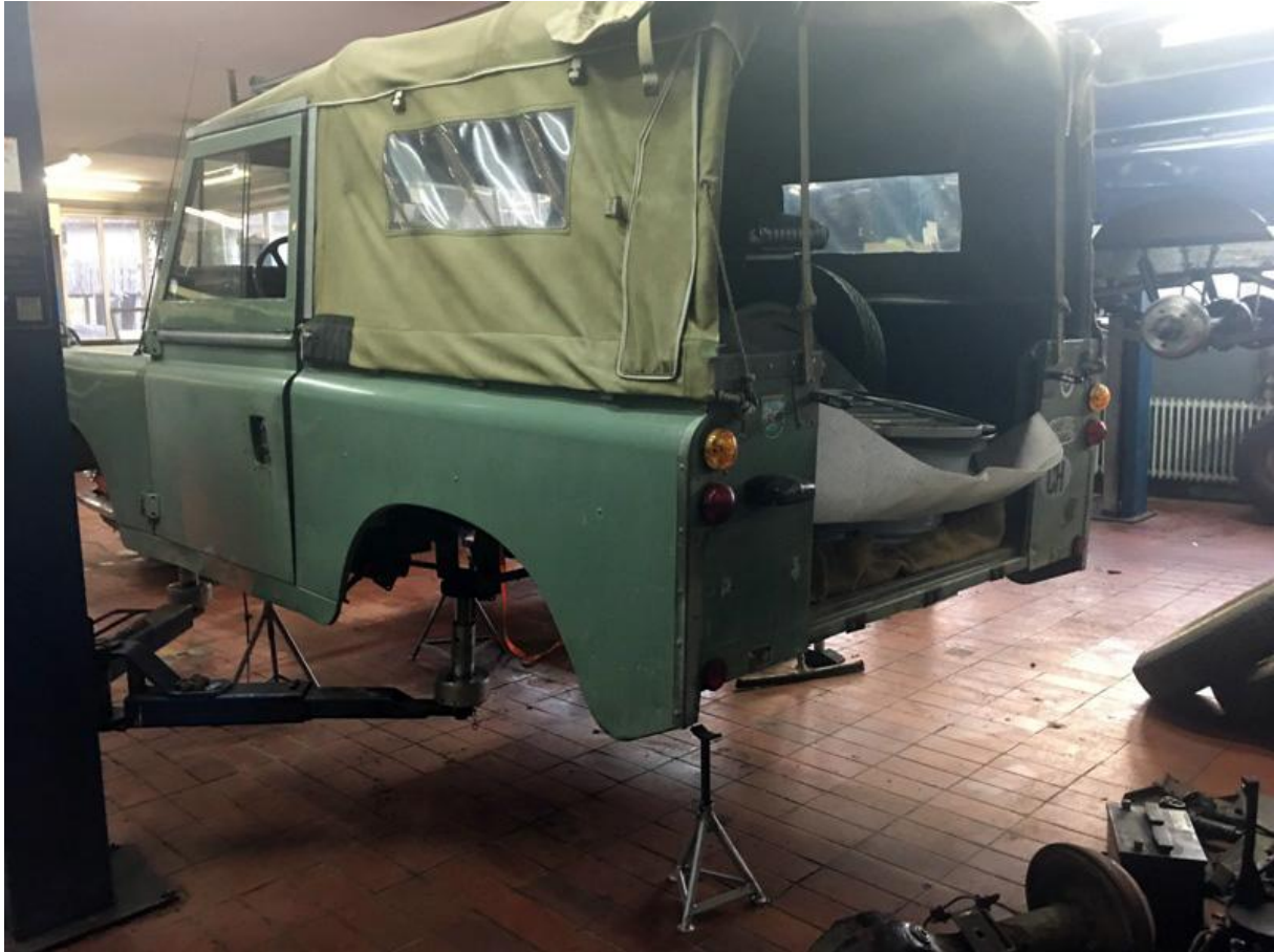
Das alte Chassis wird unter der Karosserie weggezogen und weiter zerlegt
