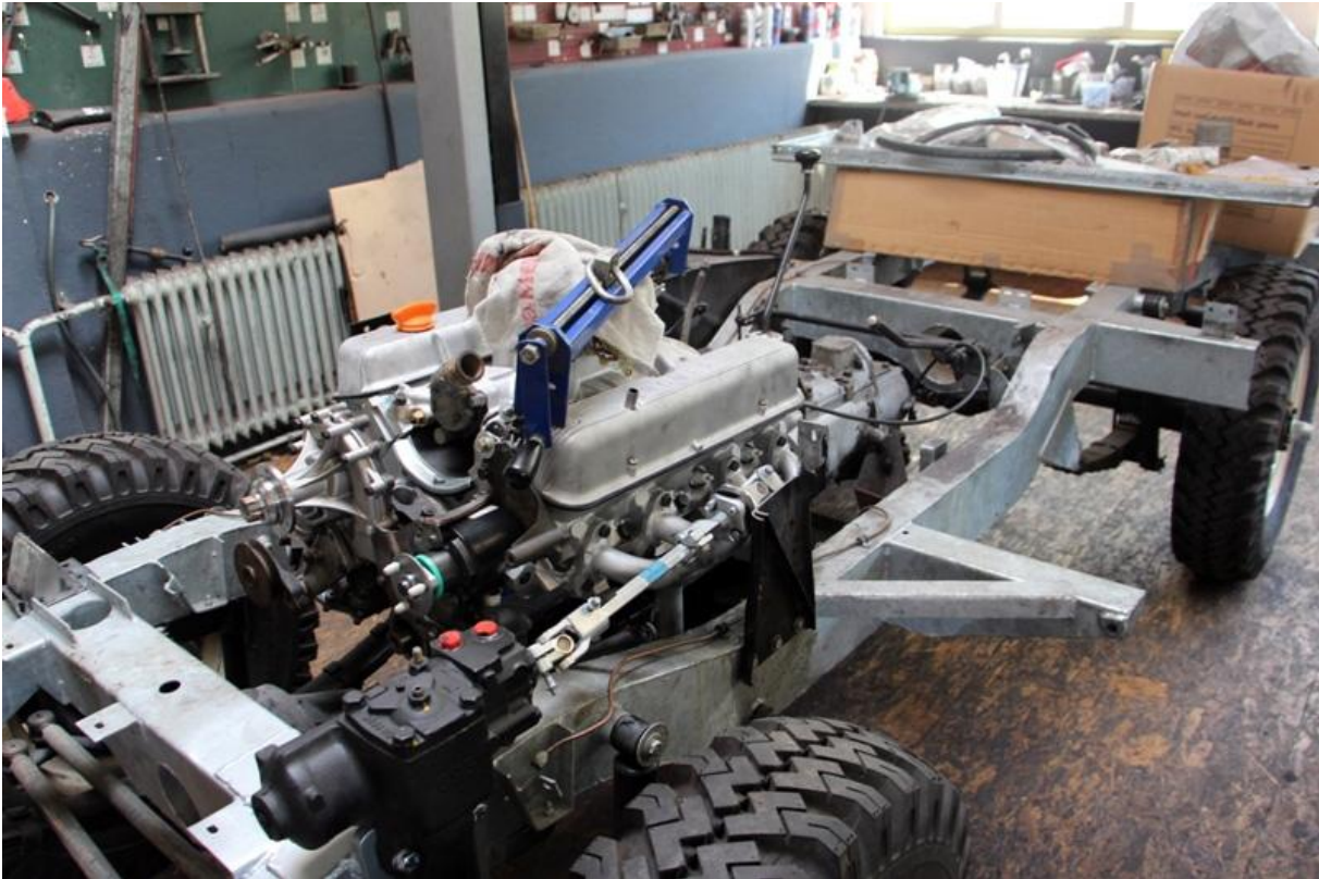
Dann wird der Motor ins Chassis gesetzt
